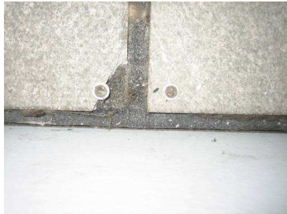
Foto 10: Prøve Asbest 4 er udtaget af grå loftsplade i viadukt under bygning ved opgang 27
